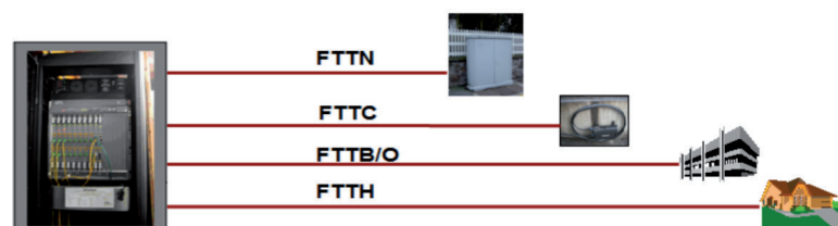
Figure 2.3 : déclinaison des architectures FTTx
