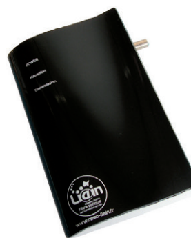
Figure 2.10 : exemple de CPE adapté à une solution RFoG (Département de l'Ain)
