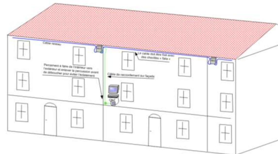
Principe d'un raccordement optique en façade
