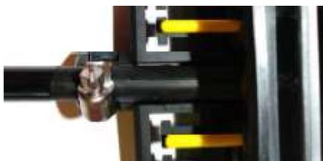
A l'intérieur du boîtier, les supports du câble sont adaptés (c'est-à-dire recoupés) à la taille du câble et l'ensemble câble + support + rilsan est clipsé dans le logement axial. Les porteurs sont correctement coupés.
